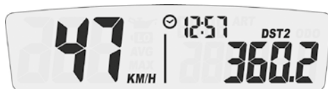
Pantalla 2 : Velocidad, Hora, DST2
