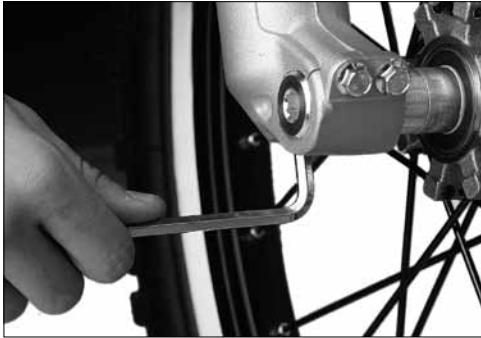
**E** Para vaciar el aceite de la suspensión delantera debe aflojarse completamente el tornillo de la parte inferior de la botella. Debe tenerse en cuenta que el mismo tornillo sujetá el anclaje de la barra. El llenado se realiza quitando el tapón superior de cada barra.
