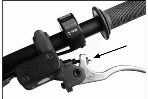
**E** El margen de tolerancia para el accionamiento del bombín del freno delantero puede ser regulado a la medida y según el usuario.
