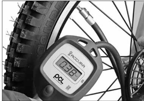
**E** Para uso standard la presión hinchado del neumático delantero debe ser de 0,4 bar. Para su uso más específico en competición puede graduarse a 0,38 bar. Para el neumático trasero -tubeless- la presión de hinchado debe ser de 0,30 bar. Para su uso en competición la presión puede reducirse hasta 0,27 bar.
