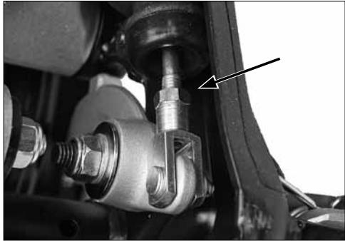
**E** La altura de la posición del pedal del freno trasero es fija, pero se puede graduar la tolerancia graduando la longitud del pistón de presión en el bombín.
