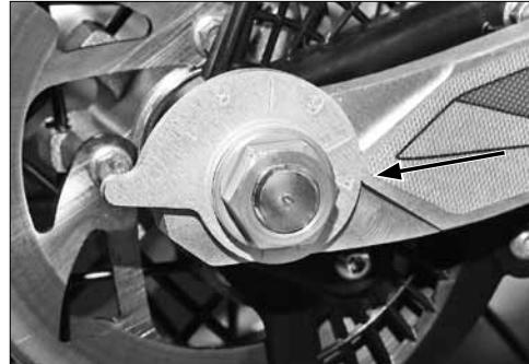
**E** Es recomendable revisar periódicamente la tensión de la cadena. Con la moto en reposo, el oscilamiento de la misma en la zona donde actúa el patín del tensor debe ser de entre 3 y 4 cms. La cadena debe ser objeto de una atención especial ya que de su buen mantenimiento depende la vida útil del conjunto piñon, corona y de la propia cadena. Es recomendable su limpieza y engrase con frecuencia. Usar grasa Minerva especial de cadena.
