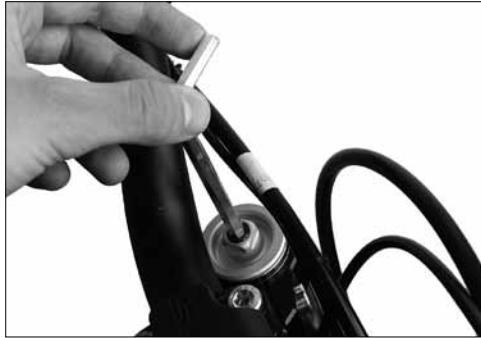
**E** La regulación de la precarga de muelle se realiza solo en la barra izquierda. Con esta regulación se establece la dureza con la que queremos trabajar la suspensión.
