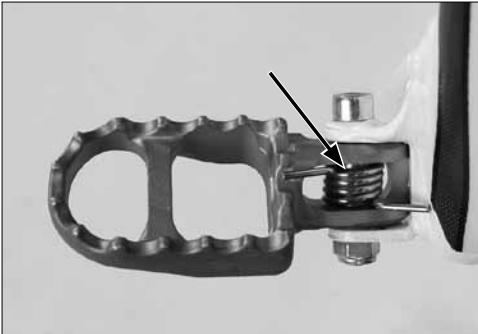
**E** El anclaje de los estribos debe estar limpio y engrasado para permitir que el estribo se pliegue en caso necesario y vuelva a su posición con la acción del muelle.
