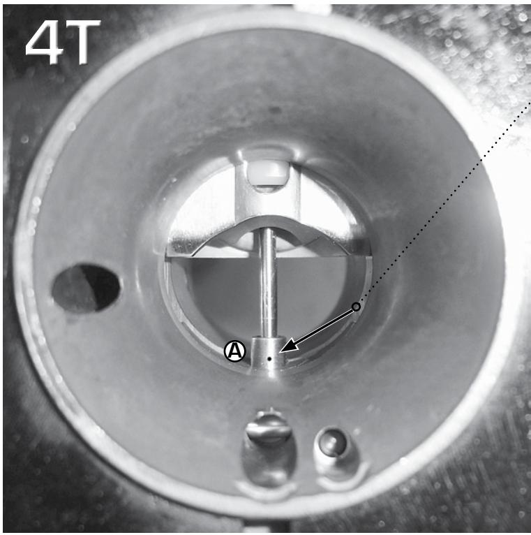
**E** Para verificar el perfecto montaje, el orificio del pulverizador debe ser visible desde la parte posterior -filtro- del carburador, como se muestra en la imagen de la vista de cono de admisión del carburador.
