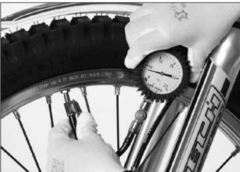
**E** Para uso standard la presión hinchada del neumático delantero debe ser de 0,4 bar. Para su uso más específico en competición puede graduarse a 0,38 bar. Para el neumático trasero -tubeless- la presión de hinchado debe ser de 0,30 bar. Para su uso en competición la presión puede reducirse hasta 0,27 bar.
