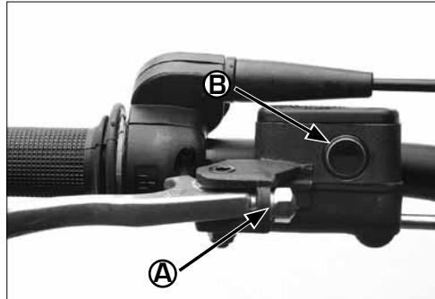
**E** Para mantener el funcionamiento del gas de forma eficiente es necesario mantener el puño del gas limpio y engrasado, así como el punto donde va anclado. Es importante verificar que el cable del gas no está forzado en ningún punto desde el manillar hasta el carburador.
