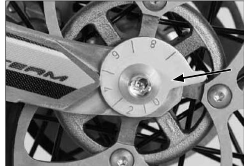
**E** Es recomendable revisar periódicamente la tensión de la cadena. Con la moto en reposo, el oscilamiento de la misma en la zona donde actúa el patín del tensor debe ser de entre 3 y 4 cms. La cadena debe ser objeto de una atención especial ya que de su buen mantenimiento depende la vida útil del conjunto piñon, corona y de la propia cadena. Es recomendable su limpieza y engrase con frecuencia. Usar grasa Minerva especial de cadena.
