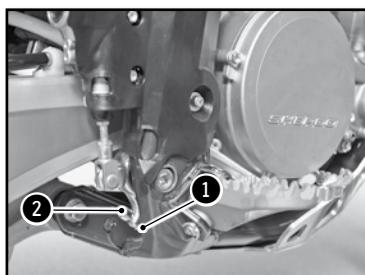
La posición del pedal de freno se regula del siguiente modo : desbloquear la contratuerca ① después apretar o aflojar el tornillo ② para encontrar la posición deseada. Apretar la tuerca una vez el pedal esté reglado.
