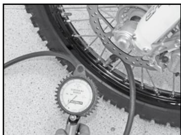
Contrôler régulièrement la pression des pneumatiques avec un manomètre de précision.
