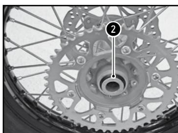
Vérifier que le disques de frein ne soit pas souillé d'huile ou de graisse. Dans ce cas, nettoyer le disques avec du nettoyant pour freins.
