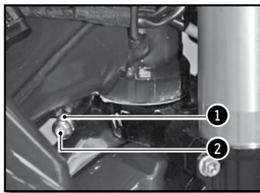
El ángulo de giro puede modificarse utilizando los tornillos de reglaje situados en los bordes inferiores de la columna de dirección.
