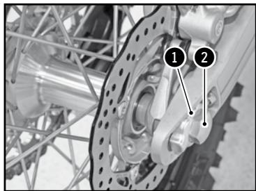
Positionner les tendeurs de chaîne ① et installer l'écrou ② mais ne pas serrer.
