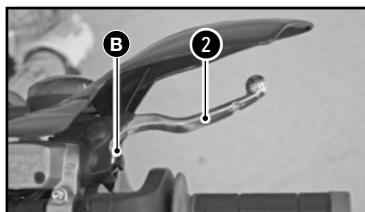
Le levier de frein avant ③ est sur le côté droit du guidon et dispose d'une vis de réglage ④
