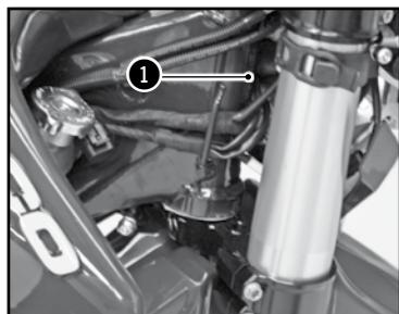
1 Le numéro de série du véhicule est frappé sur le côté droit de la colonne de direction.
