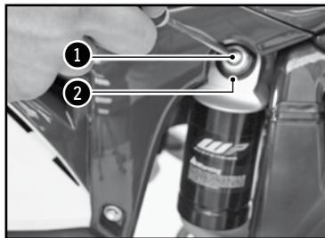
La vis de réglage ① détermine le comportement de l'amortisseur sur les compressions lentes (sensibilité). Tourner la vis dans le sens des aiguilles d'une montre augmente le frein hydraulique (et vice-versa).
