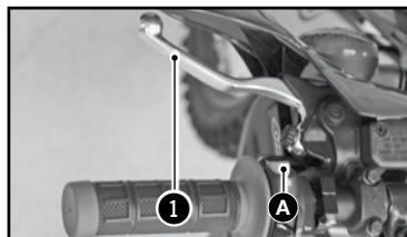
La palanca de embrague ① está en el lado izquierdo del manillar y dispone de un tornillo de regulaje A
