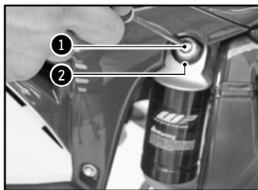
El tornillo de reglaje ① determina el comportamiento del amortiguador en compresiones lentas (sensibilidad). Girar el tornillo hacia la derecha aumenta el freno hidráulico (y viceversa).
