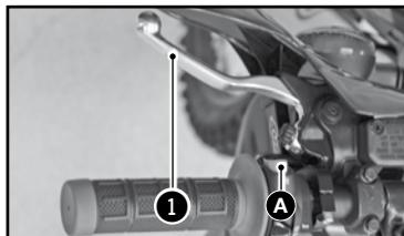
Le levier d'embrayage ① est sur le côté gauche du guidon et dispose d'une vis de réglage ②
