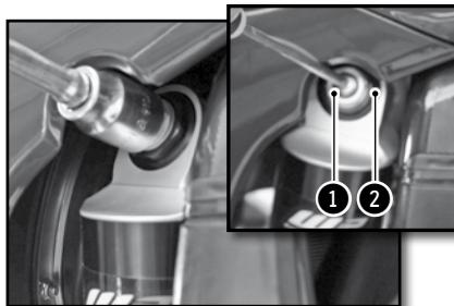
La vis de réglage ① détermine le comportement de l'amortisseur sur les compressions rapides (gros chocs). Tourner la vis dans le sens des aiguilles d'une montre augmente le frein hydraulique (et vice-versa).
