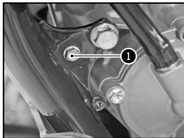
Retirer les vis **1** et écrous et retirer le sabot moteur
