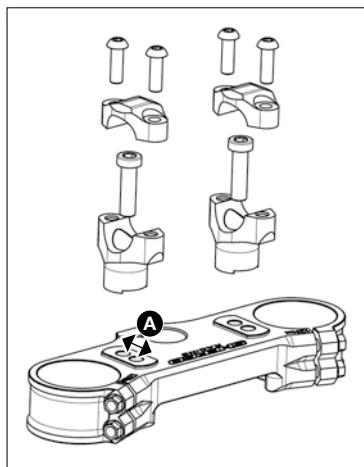
Las patas de la horquilla llevan dos orificios separados por una distancia A.
