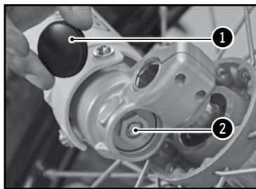
Los tornillos **2** determinan el comportamiento de la horquilla cuando se comprime. Al girarlos hacia la derecha aumenta el freno hidráulico (y viceversa).
