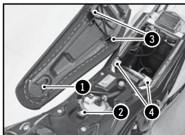
Reposer la selle vers l'avant en vous assurant que la gorge **1** est engagée dans le plot **2** du réservoir. Les encoches **3** dans la selle doivent passer dans les languettes de la boucle arrière **4** prévues à cet effet.
