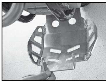
Acercar el protector del motor hacia la aparte de atrás del bastidor y girarlo hacia arriba.
