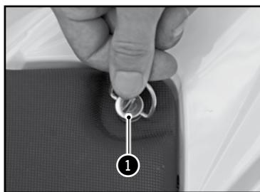
Déverrouiller d'un quart de tour dans le sens inverse des aiguilles d'une montre la vis Zeus **1** de la selle.
