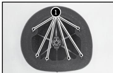
Volver a colocar el elemento filtrante en su soporte. Asegurarse de que quede bien enganado en las seis lengüetas **1**.
