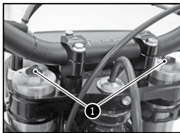
Les vis de réglage ① déterminent le comportement de la fourche lorsqu'elle se détend. Tourner les vis dans le sens des aiguilles d'une montre augmente le frein hydraulique (et vice-versa).
