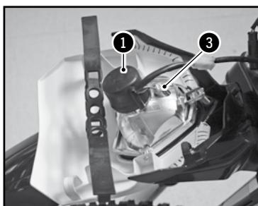
Desmontar la placa del faro y el faro (☞ p.178)
