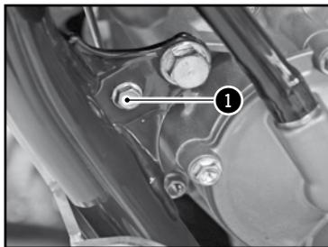
Retirar los tornillos **1** y las tuercas y retirar el protector del motor.
