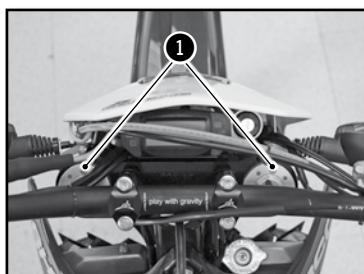
Después de algún tiempo de funcionamiento, el aire se acumula bajo presión en la horquilla. Cada 5 a 10 horas de uso (según la intensidad) se debe realizar la purga.
