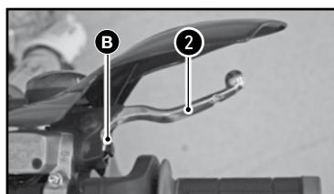
La palanca de freno delantero ② está en el lado derecho del manillar y dispone de un tornillo de regulaje B
