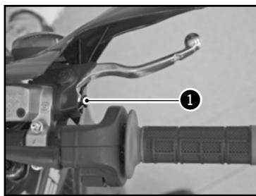
Régler la garde à l'aide de la vis de réglage **1**
