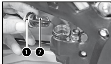
Retirer le bouchon **1** avec sa membrane **2**.
