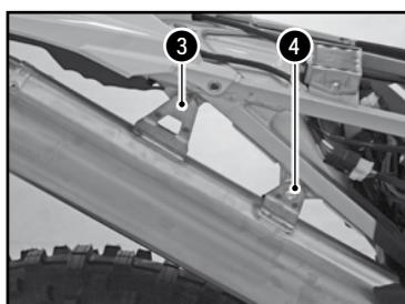
Retirer les vis **3** et **4**. Retirer le silencieux d'échappement et l'intermédiaire.
