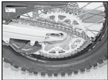
Installer la roue dans le bras et insérer l'axe de roue préalablement graissé.
