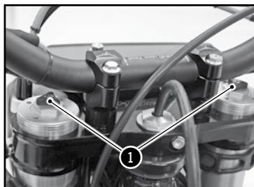
Los tornillos de reglaje ① determinan el comportamiento de la horquilla cuando se extiende. Girar los tornillos hacia la derecha aumenta el freno hidráulico (y viceversa).
