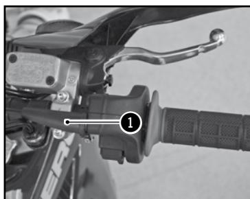
Régler la tension du câble de gaz au niveau de la poignée à l'aide du tendeur ①.
