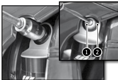
El tornillo de reglaje ① determina el comportamiento del amortiguador en compresiones rápidas (impactos grandes).
