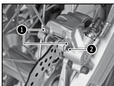
Vérifier que les disques de frein ne soient pas souillés d'huile ou de graisse. Dans ce cas, nettoyer les disques avec du nettoyant pour freins.
