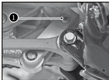
El tornillo de regulación 1 determina el comportamiento del amortiguador en distensión. Girar el tornillo hacia la derecha aumenta el freno hidráulico (y viceversa).
