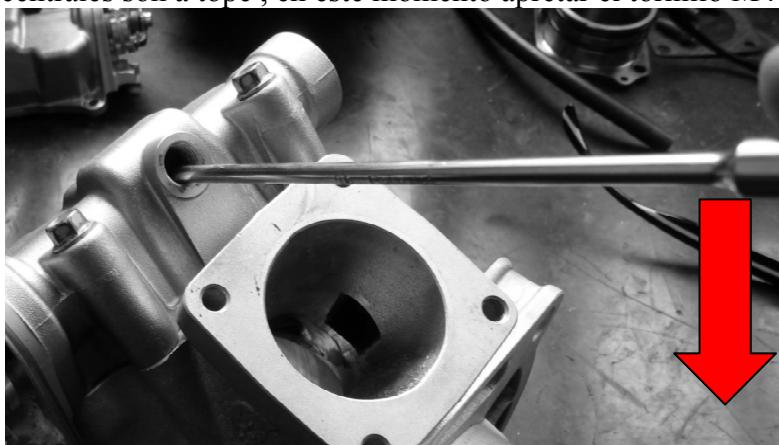
7. Démonter le couvercle de valves et retirez les 2 cales de réglages / Disable the valves cover and dismount the 2 tools spacer / Retire la tapa de válvulas y los 2 casquillos de reglaje .
