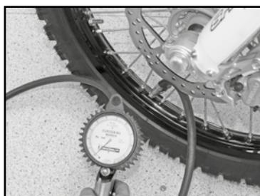
Comprobar regularmente la presión de los neumáticos con un manómetro de precisión.
