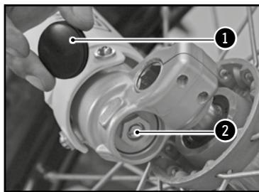
Los tornillos ② determinan el comportamiento de la horquilla cuando se comprime. Al girarlos hacia la derecha aumenta el freno hidráulico (y viceversa).
