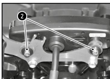
**7.** Remonter le capot en prenant garde de ne pas endommager le joint silicone.
