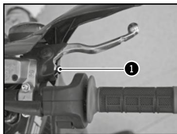
Régler la garde à l'aide de la vis de réglage **1**
