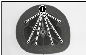
Repositionner l'élément filtrant sur son support.
