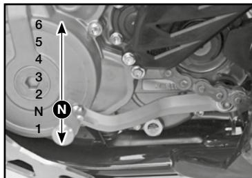
Schéma d'actions sur le sélecteur pour le passage des 6 vitesses
