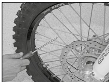
No olvidar el control y la tensión de los radios.
