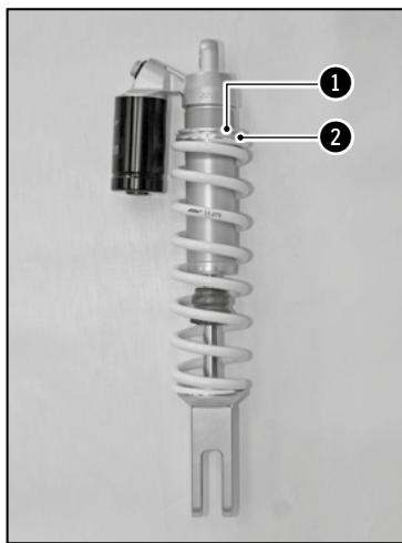
Desmontar el amortiguador y limpiarlo (☞ p.166).
