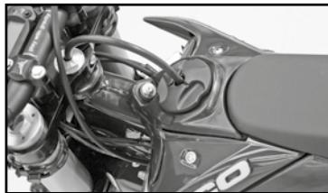
Utiliser seulement du supercarburant sans plomb d'un indice d'octane d'au moins 95
