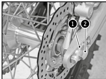
Colocar los tensores de cadena ① e instalar la tuerca ② pero sin apretar.
