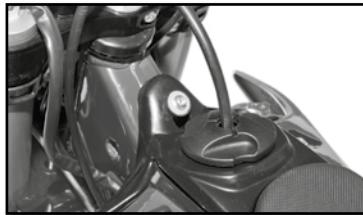
Ouverture: Tourner le bouchon dans le sens inverse des aiguilles d'une montre.
