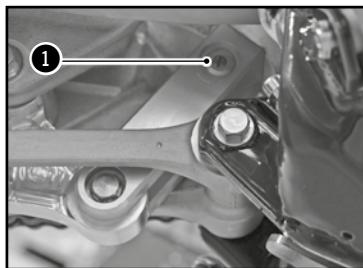
La vis de réglage ① détermine le comportement de l'amortisseur en détente. Tourner la vis dans le sens des aiguilles d'une montre augmente le frein hydraulique (et vice-versa).
