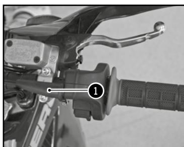
Régler la tension du câble de gaz au niveau de la poignée à l'aide du tendeur 1.
