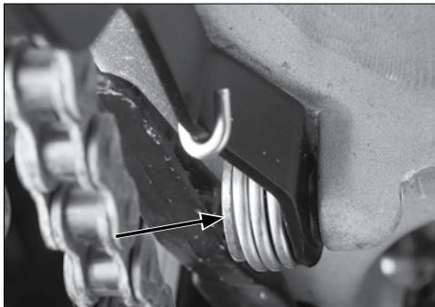
**E** El tensor de la cadena es uno de los elementos más castigados, sobretodo el muelle que es el encargado de mantener la presión sobre la cadena. Es importante mantenerlo limpio y bien engrasado.
