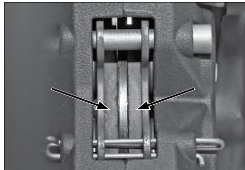
**E** Sin necesidad de desmontaje se puede comprobar de manera visual el estado de las pastillas de freno. Se recomienda la sustitución de las pastillas cuando el grosor es inferior a 2mm para mantener las máximas prestaciones de frenado. Prestar especial atención a las pastillas traseras, normalmente más castigadas.
