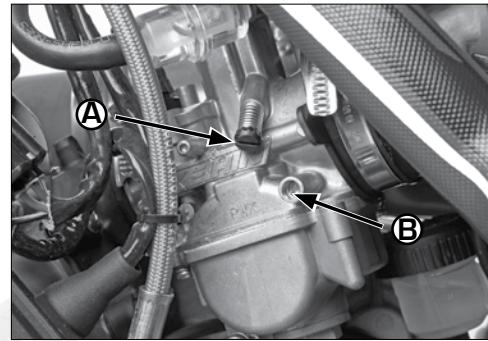
**E** En el carburador Keihin se puede regular el ralentí **(A)** y la riqueza de la mezcla **(B)** aire-gasolina. Aunque la puesta a punto viene regulada de fábrica, dependiendo de la altura y condiciones climáticas puede requerir pequeños ajustes.
