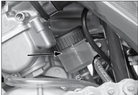
**E** Verificar el nivel del líquido Minerva del freno trasero. El depósito es fácilmente visible desde el lado izquierdo de la moto, justo detrás del carburador.
