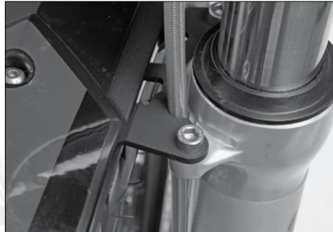
**E** Prestar atención a la ubicación del latiguillo del freno delantero. El soporte del guardabarros delantero dispone de un anclaje específico por donde debe pasar el latiguillo. Este posicionamiento es importante para favorecer su buen funcionamiento.
