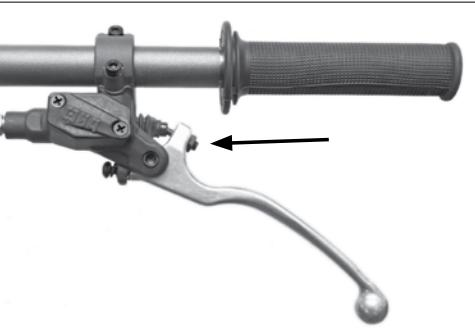
**E** El margen de tolerancia para el accionamiento del bombín del embrague puede ser regulado según el usuario. Es recomendable mantener un margen de tolerancia para evitar cualquier presión sobre el bombín.
