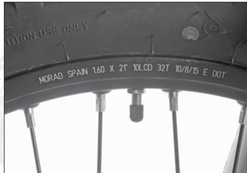
**E** Para uso standard la presión de hinchado del neumático delantero debe ser de entre 0,38 y 0,40 bar. Para el neumático trasero -tubeless- la presión de hinchado debe ser de entre 0,27 y 0,30 bar. Para recorridos en excursiones largas, es recomendable utilizar la mayor presión posible recomendada.
