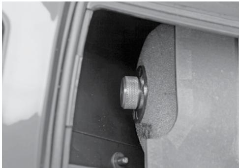
**E** Es muy importante realizar operaciones periódicas de limpieza del filtro de aire, sobretodo cuando el uso de la moto se realiza en entornos polvorientos. Antes del montaje es importante aplicar aceite Minerva especial para filtros.
