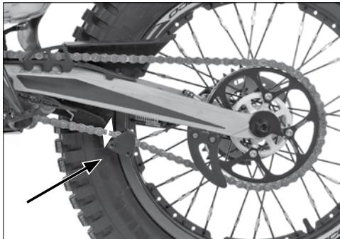
**E** Es recomendable revisar periódicamente la tensión de la cadena. Con la moto en reposo, el oscilamiento de la misma en la zona donde actúa el patín del tensor debe ser de entre 3 y 4 cms. La cadena debe ser objeto de una atención especial ya que de su buen mantenimiento depende la vida útil del conjunto piñón, corona y de la propia cadena. Es recomendable su limpieza y engrase con frecuencia. Usar grasa Minerva especial para cadena.
