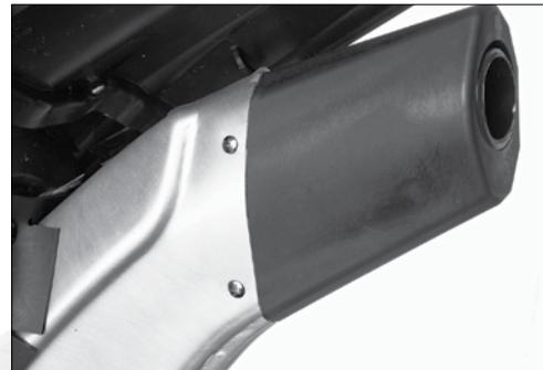
**E** El silenciador del tubo de escape incorpora una parte final desmontable fijada por solo tres tornillos. Permite la manipulación y el cambio de fibras del silenciador.
