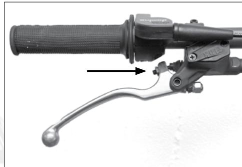
**E** Para mantener el funcionamiento del gas de forma eficiente es necesario mantener el puño del gas limpio y engrasado, así como el punto donde va anclado. Es importante verificar que el cable del gas no esté forzado en ningún punto desde el manillar hasta el carburador.
