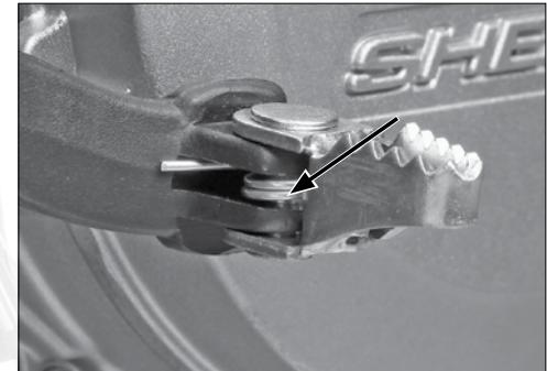
**E** La altura de la posición del pedal del freno trasero es fija, pero se puede graduar la tolerancia graduando la longitud del pistón de presión en el bombín.
