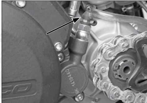
**E** Si se desmonta o sustituye el latiguillo de conexión entre la maneta de embrague y el bombín, este dispone de un purgador para evacuar el aire, apretando la maneta y aflojando el purgador sucesivamente, hasta eliminar todo el aire del circuito.
