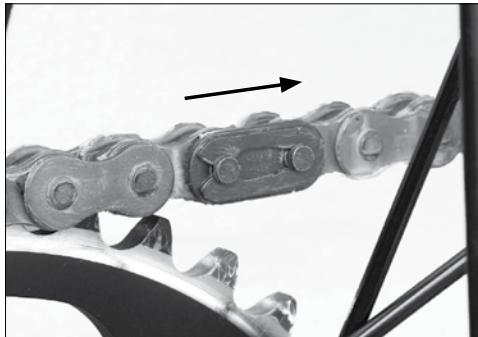
**E** En el caso de cualquier operación en la cadena que necesite de su desmontaje o en la sustitución de la misma, prestar especial atención al colocar el enganche de cadena. La parte cerrada siempre debe estar dirigida hacia el sentido de giro de la rueda.
