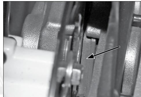
**F** Vérifier le niveau du liquide de frein arrière Minerva. Le réservoir est facilement visible sur le côté gauche de la moto, juste derrière le carburateur.
