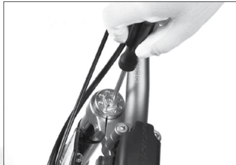
**E** En la barra derecha se regula el hidráulico. Con esta regulación se ajusta directamente la rapidez de funcionamiento sobretodo en capacidad de absorción y retorno.
