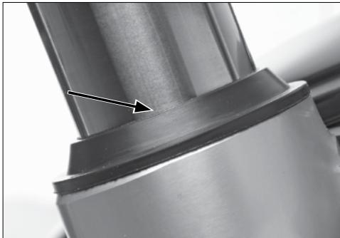
**E** Limpiar y verificar con frecuencia las gomas de sellado o guardapolvos de las barras de suspensión delantera. Su buen cuidado favorece su conservación y buen funcionamiento.
