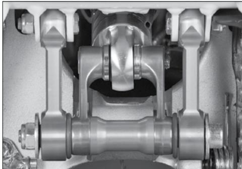
**F** Le groupe d'ancrages et bielettes de la suspension postérieure doit être révisé, nettoyé et lubrification périodiquement. De sa bonne fonctionnalité dépend dans une grande mesure le fonctionnement correct de la suspension arrière.
