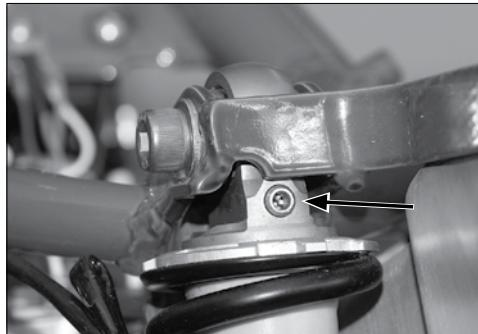
**F** El amortiguador trasero puede ser regulado tanto en precarga -muelle- como en hidráulico. Para regular el muelle se debe ajustar su longitud gracias al doble conjunto de anillo dentado roscado que sirve para graduar y fijar su posición. El hidráulico se puede graduar mediante el tornillo en la parte superior del amortiguador. Cualquier operación que se realice mantiene invariable el recorrido del amortiguador. Los ajustes de fábrica se basan en un peso del piloto de entre 70-80 kgs.
