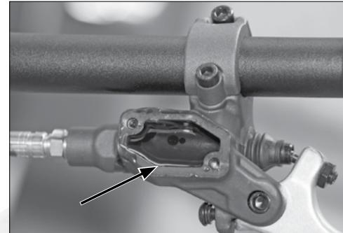
**E** Una vez completado el proceso de purga o eliminación del aire del latiguillo, comprobar el nivel de líquido en el depósito antes de dar por completada la operación.
