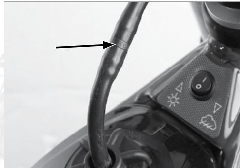
**E** El tubo de entrada de aire del depósito incorpora un dispositivo para permitir la entrada de aire e impedir que pueda salir gasolina. Prestar atención en la indicación que marca su montaje correcto. En caso de mal montaje puede influir en el mal suministro de gasolina al carburador.
