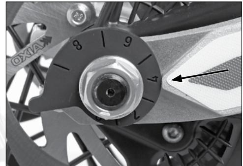
**E** En caso del desmontaje de la rueda trasera o para tensar la cadena si es necesario, la posición del eje se regula mediante excéntricas con numeros de referencia para mayor precisión.
