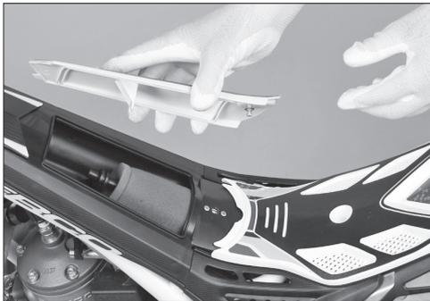
**E** El mantenimiento del filtro de aire es ahora mucho más fácil en la nueva Sherco. Este va instalado justo donde antes estaba el depósito de combustible. Para acceder al conjunto filtrante se puede realizar sin la ayuda de ninguna herramienta. Una vez limpio el filtro es recomendable aplicar aceite Minerva especial para filtros
