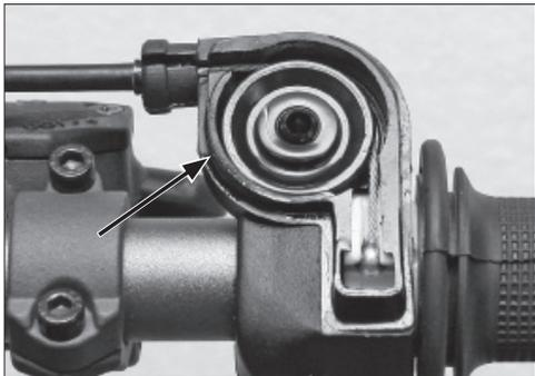
**E** Para mantener el funcionamiento del gas de forma eficiente es necesario mantener el puño del gas limpio y engrasado, así como el punto donde va anclado. Es importante verificar que el cable del gas no está forzado en ningún punto desde el manillar hasta el carburador.
