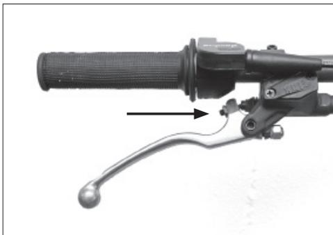
**E** El margen de tolerancia para el accionamiento del bombín del freno delantero puede ser regulado a la medida y según el usuario.
