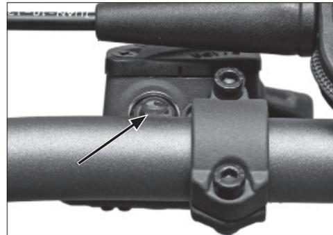
**E** Controlar el nivel del líquido Minerva de freno delantero.
