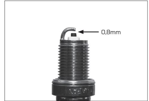
**E** La bujía nos permitirá saber si el motor realiza la combustión correctamente. Además de estar en perfecto estado, las medidas del electrodo y el arco deben mantenerse las estipuladas por el fabricante.
