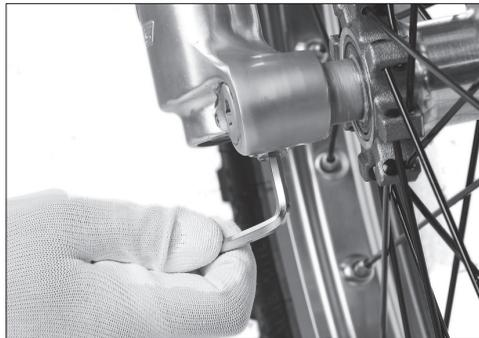
**E** Para vaciar el aceite de la suspensión delantera debe aflojarse completamente el tornillo de la parte inferior de la botella. Debe tenerse en cuenta que el mismo tornillo sujeta el anclaje de la barra. El llenado se realiza quitando el tapón superior de cada barra.
