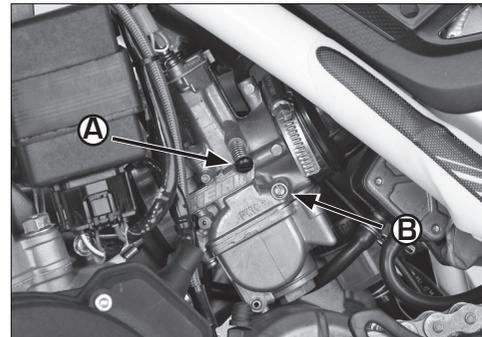
**E** En el carburador Dell'Orto se puede regular el ralentí **A** y la riqueza de la mezcla **B** aire-gasolina. Aunque la puesta a punto viene regulada de fábrica, dependiendo de la altura y condiciones climáticas puede requerir pequeños ajustes.
