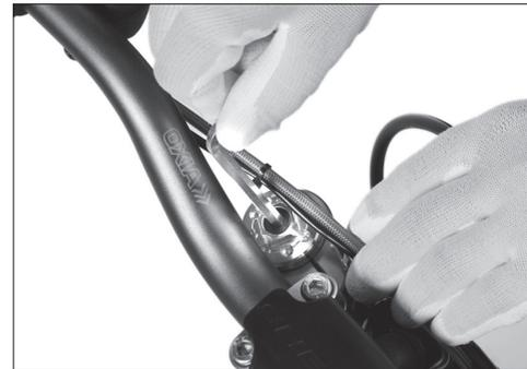
**E** La regulación de la precarga de muelle se realiza solo en la barra izquierda. Con esta regulación se establece la dureza con la que queremos trabaje la suspensión.
