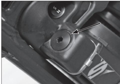
**E** El circuito de refrigeración se puede llenar por el propio radiador, provisto de una boca de entrada en su lado izquierdo. La operación debe realizarse siempre con el motor en frío.
