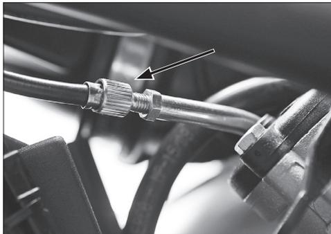
**E** El cable del gas nunca debe estar en tensión. La tolerancia del cable del gas viene regulada de fábrica, pero el usuario también puede graduarlo con el tensor a rosca que une la funda del cable con el carburador.
