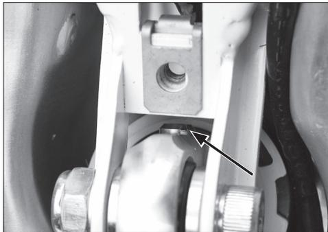
**E** El amortiguador trasero puede ser regulado tanto en precarga -muelle- como en hidráulico. Para regular el muelle se debe ajustar la longitud del muelle gracias al doble conjunto de anillo dentado roscado que sirve para graduar y fijar su posición. Para graduar el hidráulico se puede realizar con un destornillador. Cualquier operación que se realice mantiene invariable el recorrido del amortiguador.
