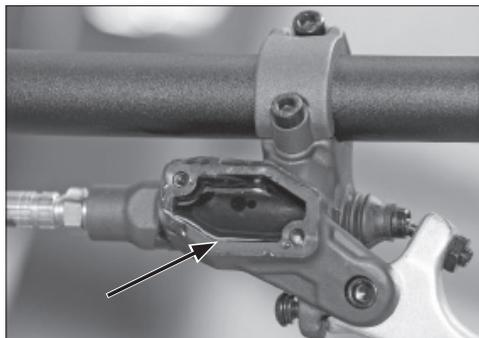
**E** Controlar el nivel del líquido Minerva del depósito del embrague hidráulico.
