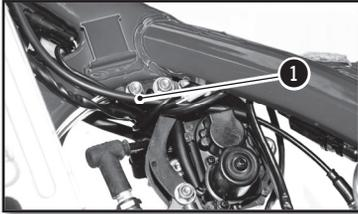
S'assurer du bon positionnement du câble de gaz **1** et de la durite d'embrayage **2**.
