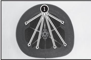
Volver a colocar el elemento filtrante en su soporte. Asegurarse de que quede bien enganchado en las seis lengüetas **1**.
