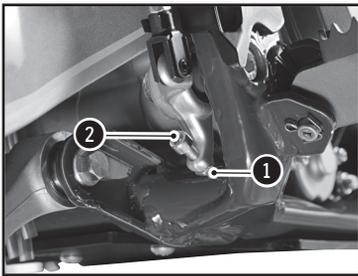
La posición del pedal de freno se regula del siguiente modo : desbloquear la contratuerca 1 después apretar o aflojar el tornillo 2 para encontrar la posición deseada. Apretar la tuerca una vez el pedal esté reglado.
