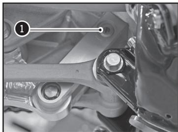
El tornillo de reglaje ❶ determina el comportamiento del amortiguador en distensión. Girar el tornillo hacia la derecha aumenta el freno hidráulico (y viceversa).
