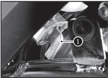
Le robinet d'essence est situé sur le côté droit du réservoir de carburant.
