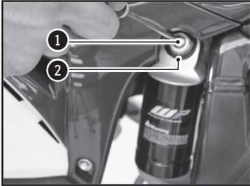
El tornillo de reglaje **1** determina el comportamiento del amortiguador en compresiones lentas (sensibilidad). Girar el tornillo hacia la derecha aumenta el freno hidráulico (y viceversa).
