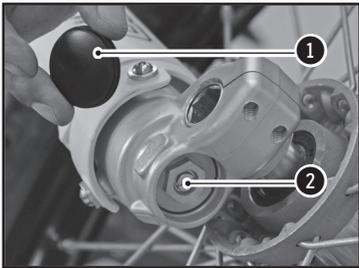
Les vis **2** déterminent le comportement de la fourche quand elle se comprime. Les tourner dans le sens des aiguilles d'une montre augmente le frein hydraulique (et vice-versa).
