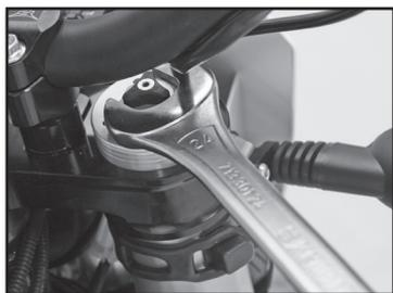
L'écrou de réglage permet le réglage de la précontrainte du ressort. Tourner l'écrou dans le sens des aiguilles d'une montre augmente la précontrainte (et vice-versa).
