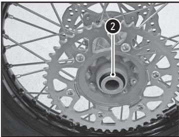
Vérifier que le disque de frein ne soit pas souillé d'huile ou de graisse. Dans ce cas, nettoyer le disque avec du nettoyant pour freins.
