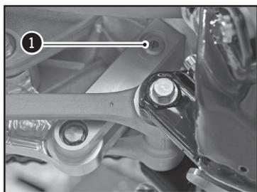
La vis de réglage ❶ détermine le comportement de l'amortisseur en détente. Tourner la vis dans le sens des aiguilles d'une montre augmente le frein hydraulique (et vice-versa).
