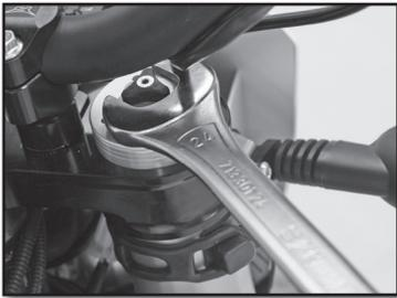
La tuerca de reglaje permite el reglaje de la precarga del muelle. Girar la tuerca hacia la derecha aumenta la precarga (y viceversa).
