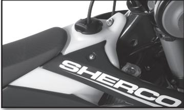
Utiliser seulement du supercarburant sans plomb d'un indice d'octane d'au moins 95 mélangé avec de l'huile moteur 2T.
