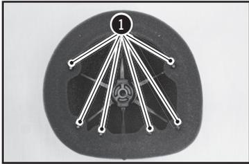
Repositionner l'élément filtrant sur son support. Veiller à bien l'engager sur les six ergots **1**. Appliquer une pellicule de graisse sur la face avant du filtre.
