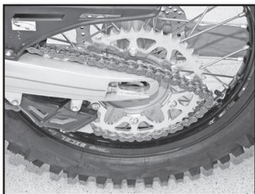
Installer la roue dans le bras et insérer l'axe de roue préalablement graissé.
