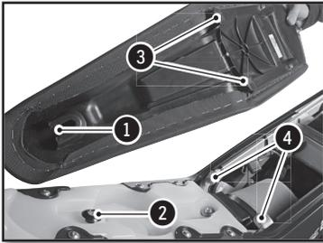
Volver a montar el sillín hacia delante asegurándose de que quede **1** enganchado en la plataforma **2** del depósito. Las muescas **3** del sillín deben pasar por dentro de las lengüetas del bastidor secundario **4** previstas para ello.
