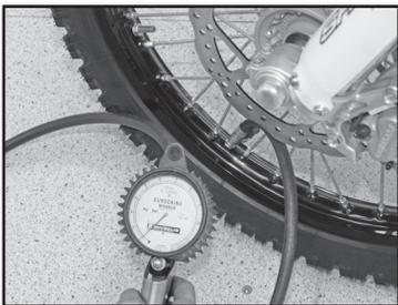
Comprobar regularmente la presión de los neumáticos con un manómetro de precisión.
