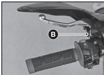
La posición de la palanca puede modificarse en función de la fisonomía del piloto.
