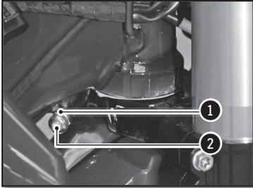
L'angle de braquage peut-être modifié en utilisant les vis de réglages situées sur les bords inférieurs de la colonne de direction.
