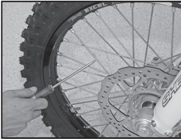
No olvidar el control y la tensión de los radios.
