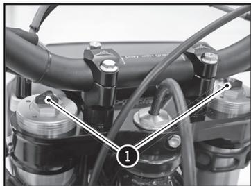
Les vis de réglage ❶ déterminent le comportement de la fourche lorsqu'elle se détend. Tourner les vis dans le sens des aiguilles d'une montre augmente le frein hydraulique (et vice-versa).
