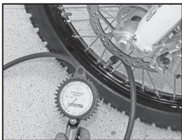
Contrôler régulièrement la pression des pneumatiques avec un manomètre de précision.
