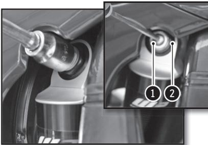
El tornillo de reglaje **1** determina el comportamiento del amortiguador en compresiones rápidas (impactos grandes).
