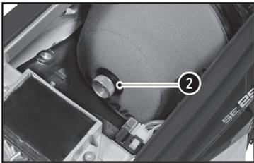
Réinstaller le filtre avec son support en prenant un soin particulier à son centrage. Remonter la vis moleté **2**. Vérifier que le filtre à air est bien en place. Remonter la selle (☛ p.36)
