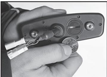
1. Desmontar la placa faro y el faro (☛ p.184)
