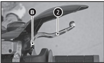
Le levier de frein avant **2** est sur le côté droit du guidon et dispose d'une vis de réglage **B**
