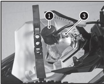
Desmontar la placa del faro y el faro (☛ p.184)
