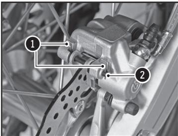
Vérifier que les disques de frein ne soient pas souillés d'huile ou de graisse. Dans ce cas, nettoyer les disques avec du nettoyant pour freins.
