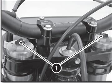
Los tornillos de reglaje ❶ determinan el comportamiento de la horquilla cuando se extiende. Girar los tornillos hacia la derecha aumenta el freno hidráulico (y viceversa).
